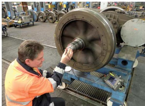
Ultraschalluntersuchung an einer Radsatzwelle eines U-Bahn-Fahrzeuges der Hamburger Hochbahn AG
